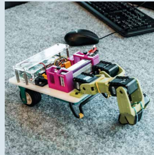
Informatik-Studierende haben den Krabbelroboter »RoboCrawler« konzipiert. Beim KI-Tag der HTWG erklärten sie, wie er durch eigenständiges und bestärkendes Lernen (reinforcement learning) Krabbeln lernt.
